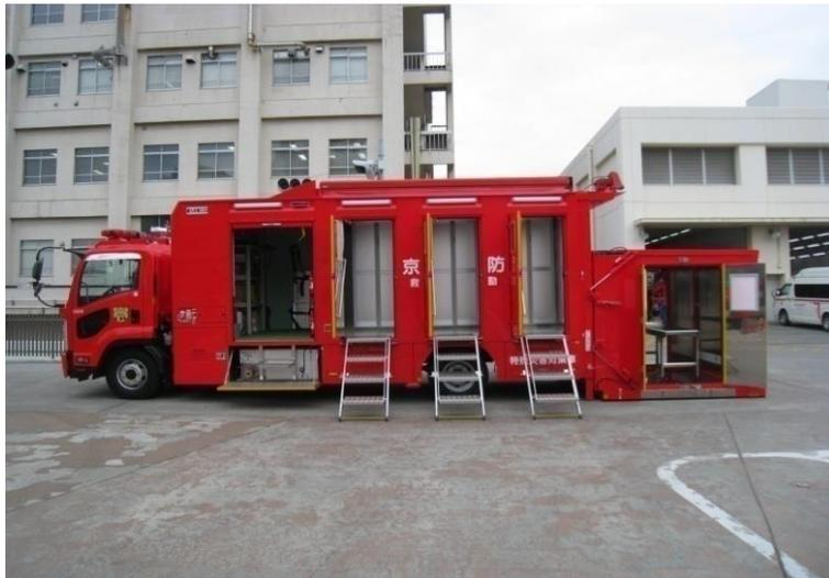
NBC災害現場での除染活動に対応するために、脱衣兼シャワー室、着衣室、制御室兼資器材収納室及び折りたたみ可能な昇降式の担架搬送用シャワー室を設け、シャワー設備、給湯設備、発電設備、テント設備、昇降式照明装置、給排水槽等を装備した車両です。
