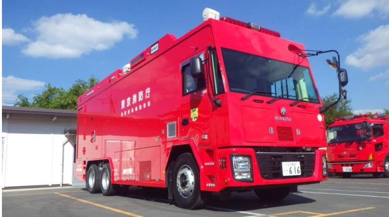
放射性物質・化学剤・生物剤のNBC災害発生時に対応するため、車内陽圧式空気清浄装置を装備し、毒劇物等の車両内部への流入防止機能を有します。また、鉛板及び水槽でボディーを覆うことにより放射線防護機能を有し、検知型遠隔探査ロボット、監視カメラ、外付けの放射能測定器を装備するとともに、外部空気を社内の測定機に取り込み安全な車内にて分析することができます。
