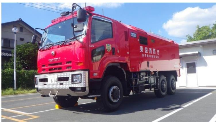
全輪駆動シャシーを採用し、車内陽圧式空気浄化装置、外付けの放射能測定器・生物剤検知器・化学剤検知器、監視カメラ、超音波風向風速計を装備しています。空気浄化装置は取り入れた車外の空気に対して $0.3\mu\text{m}$ の粉塵を99.99パーセント除去でき、測定データを車内で把握することができ、悪路等の災害現場において安全な車内にて偵察することができます。
