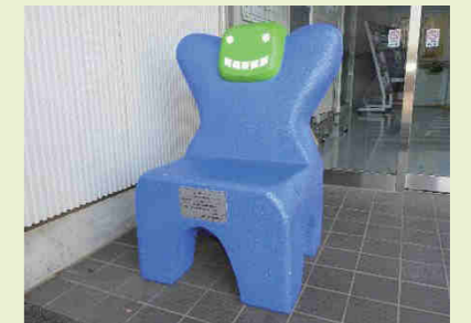
焼却灰エコセメント化事業による コンクリート製ベンチ「エコタロー」
